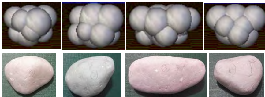
図 5-5 水路に投入した石礫粒子の形状
