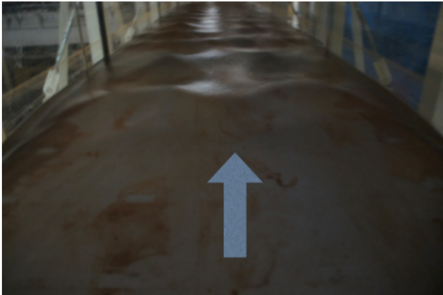
写真 4-2 実験水路での波状跳水を伴う水面形
