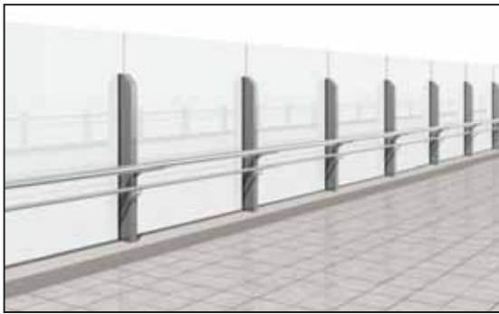
図-9.11 防風板(高さ h=2.0\text{m} 、幅 b=2.0\text{m} ) 3)
