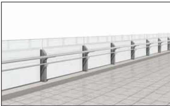
図-9.13 高欄(高さ h=1.2\text{m} 、幅 =2.0\text{m} ) 3)
