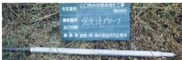
写真-5.8 RI コーンプローブ (密度計プローブ)
