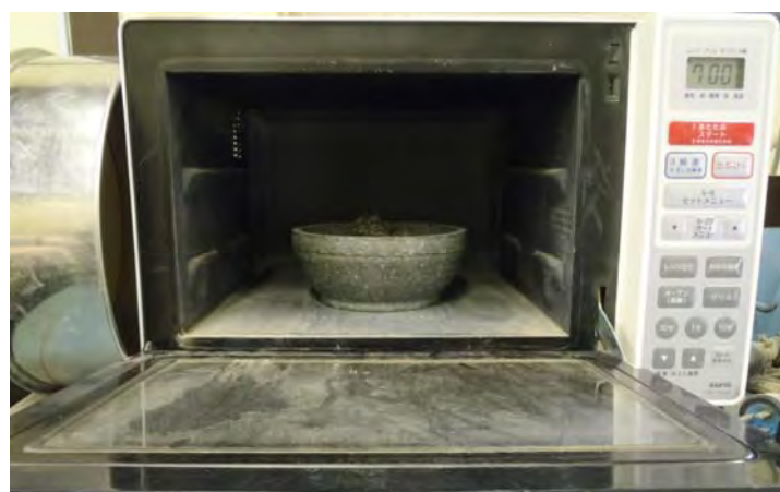
写真-7.18 電子レンジ法による含水率試験状況
