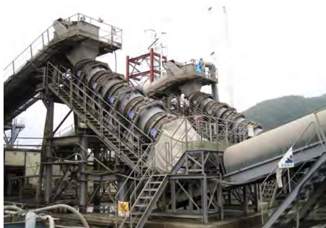
写真-7.3 連続式 CSG 混合機 (SP ミキサー, 当別ダム, 2009 年, 著者撮影)
