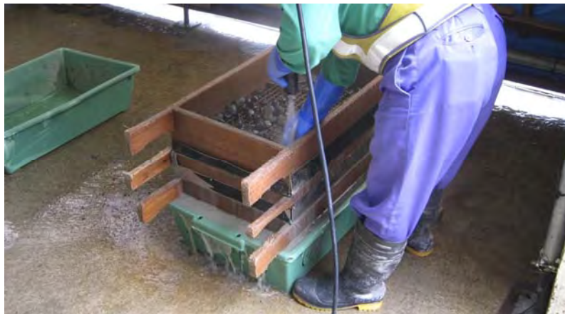
写真-7.16 湿潤・水洗い法による粒度試験状況
