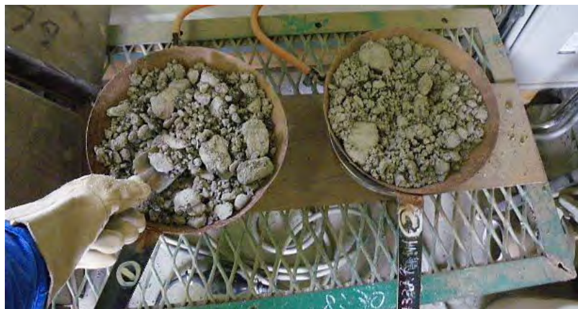
写真-7.17 フライパン法による含水率試験状況
