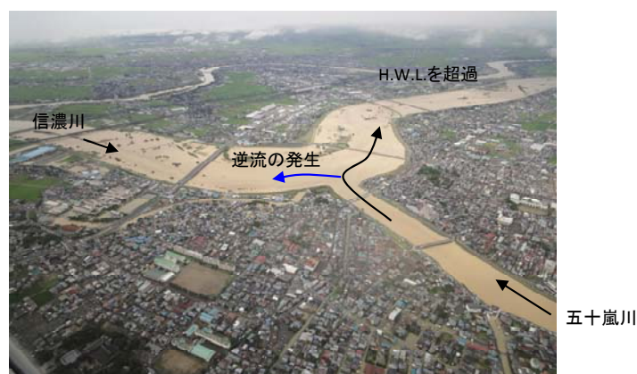
写真 2-1 平成 23 年 7 月洪水における信濃川・五十嵐川合流部の状況
