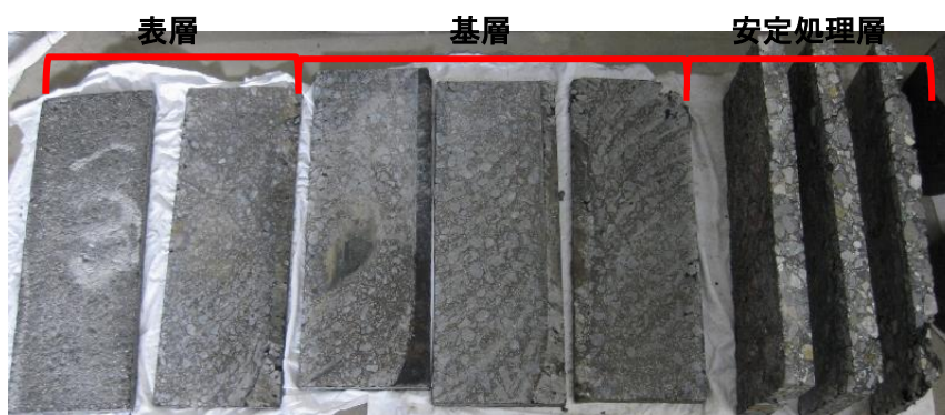
写真 - 2.6 39 工区 車両非通行部より採取した試料（密粒，非健全部）
