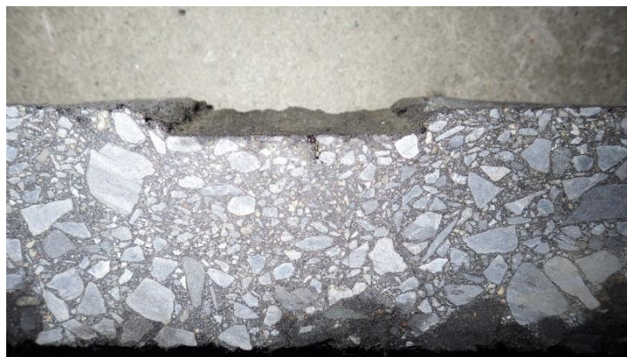
写真-5.3 車輪走行部の表面でひび割れが生じた供試体の断面写真
