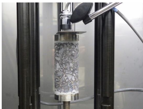
写真-5.7 Push-pull 試験の供試体設置状況
