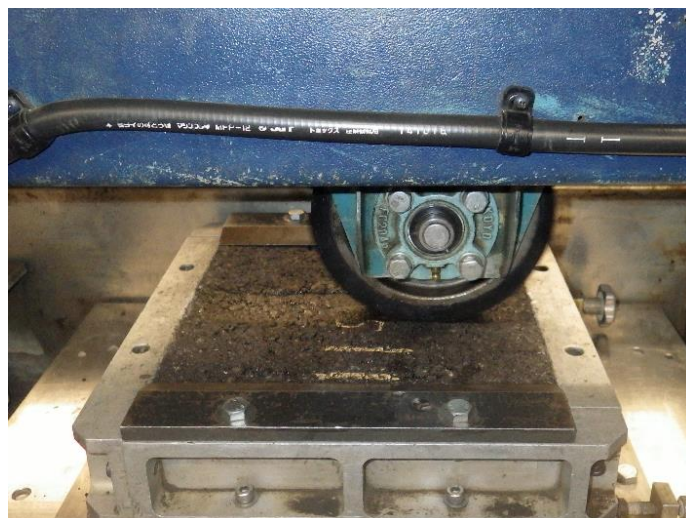
写真-5.1 WT 疲労試験の実施状況
