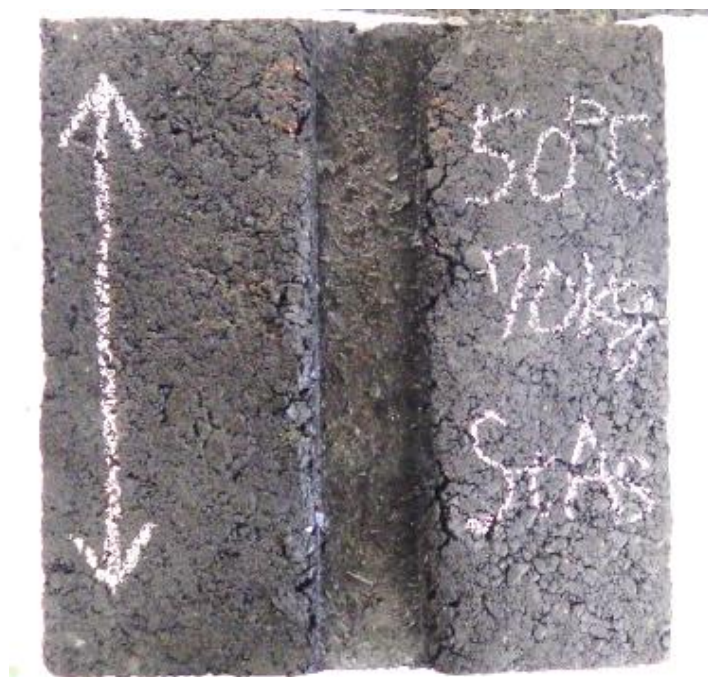
写真-5.3 車輪走行部の表面でひび割れが生じた供試体の断面写真
