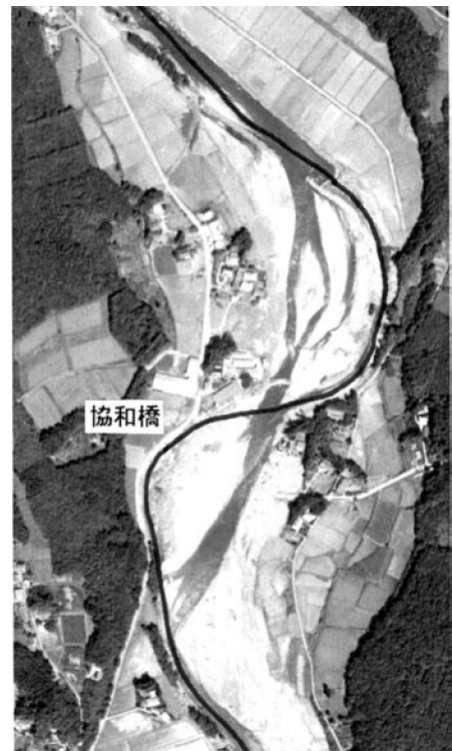
写真 3-1-2 1998年8月洪水で湾曲部をショートカットして新流路形成状況 3) (太線が被災前流路の中心線)
