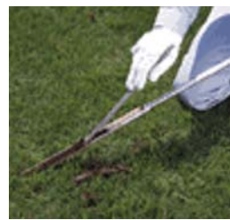
写真6-3-1 検土杖の概要および調査状況
