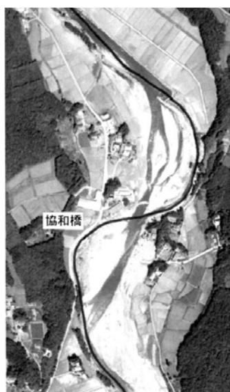
写真 5-6-1 湾曲部内岸側の側方侵食で湾曲部の流路がショートカットされた様子
