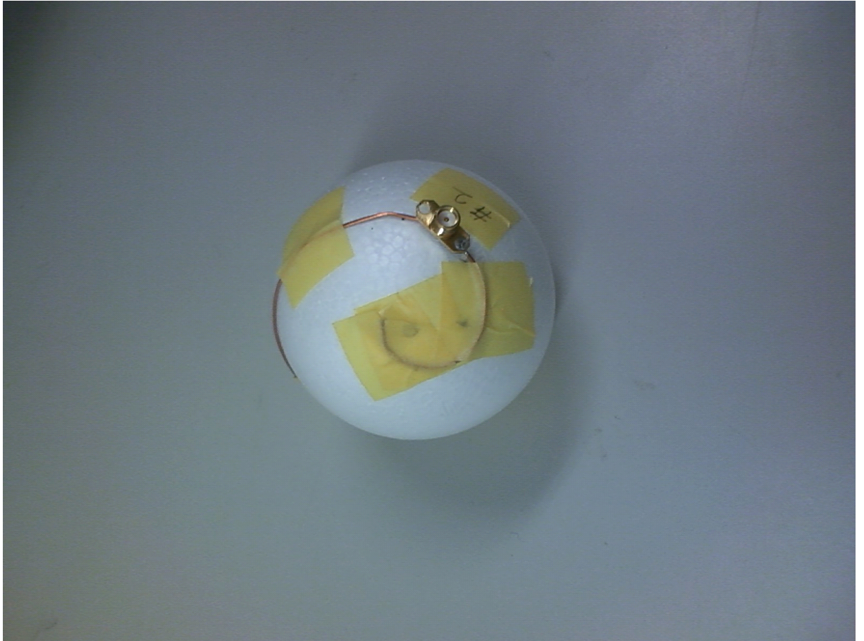
図 5.21: 製作した球ヘリカルアンテナ.
