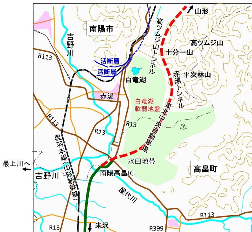
図 2-2 白竜湖軟弱地盤の周辺状況 (国土地理院標準地図, 都市圏活断層図を用いて作成)
