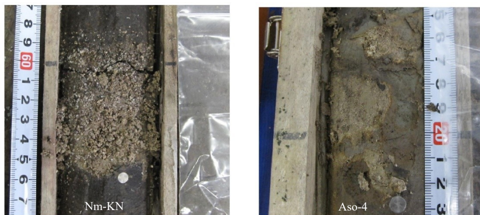
図 3-6 テフラの産状の例 (写真提供：株式会社ネクスコ・エンジニアリング東北)
