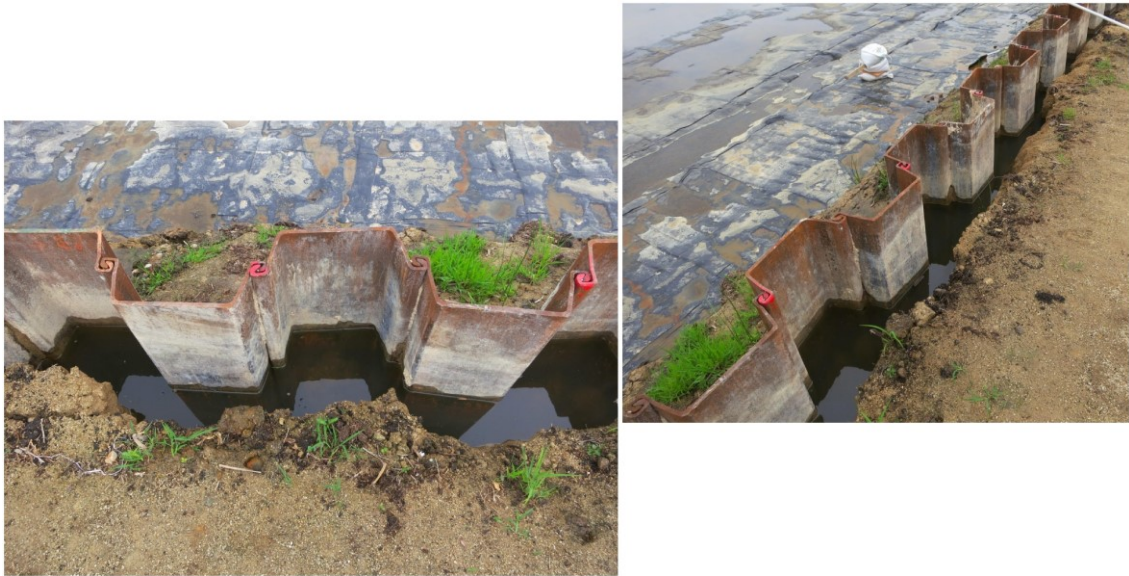
図 4-2 2 負圧載荷時の改良範囲端部付近の状況 (Area1)
