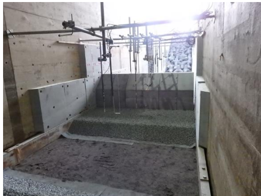
図 4.1-4 上部斜面堤(固定実験)の模型設置状況
