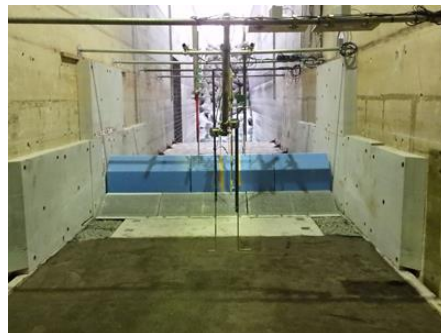
図 4.1-2 上部斜面堤(固定実験)の模型設置状況
