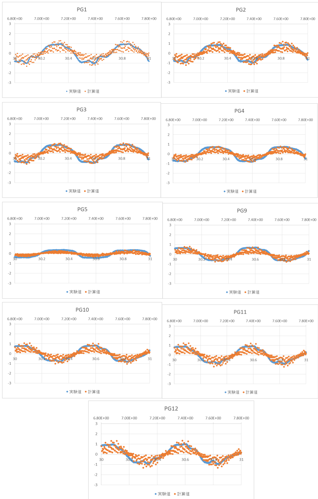
図 5.2-4 case1(時間刻み 0.01s, 粒子サイズ 0.05m)における実験値と計算値の比較
