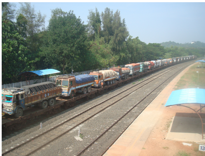
写真2 インド国コンカン鉄道の Karmali 駅で現認したピギーバックによる貨物列車1編成のトレーラーが50両で、ディーゼル機関車を含めると全長は500mを超える。
