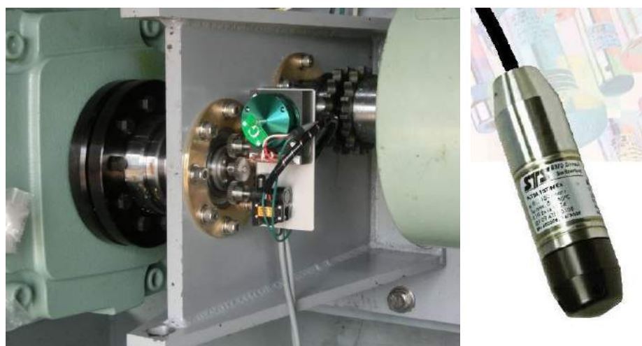
図4.5 浮体上下位置センサーと波センサー（圧力計）
