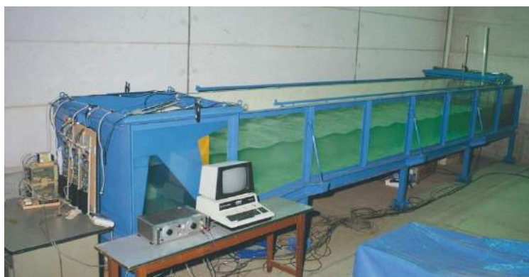
図 1.13 日本に導入された Salter の吸収式造波装置
