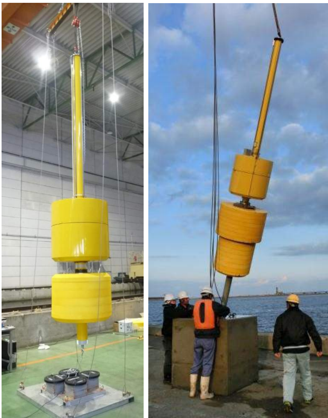
図 3.2 円柱浮体による吸収運転
