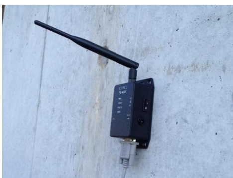
図 2-1 3 ワイヤレス信号処理ユニット (ALNIC 社製 RS-AD24)
