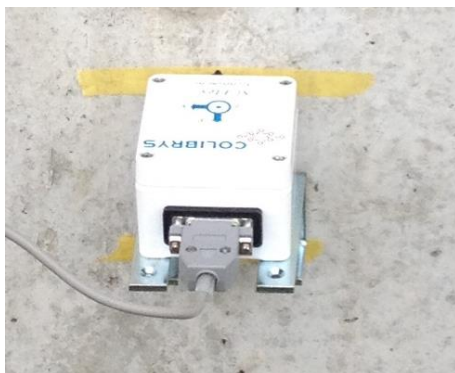
図 2-1 2 加速度センサー (COLIBRYS 社製 SF3000L)
