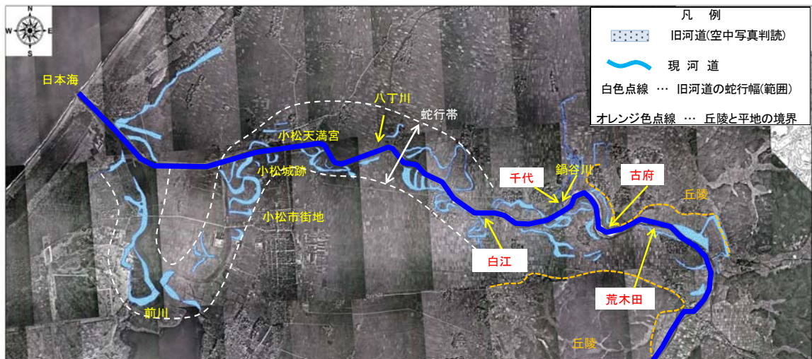
図5-1-1 梯川の米軍撮影の空中写真による旧河道判読図と漏水発生箇所
