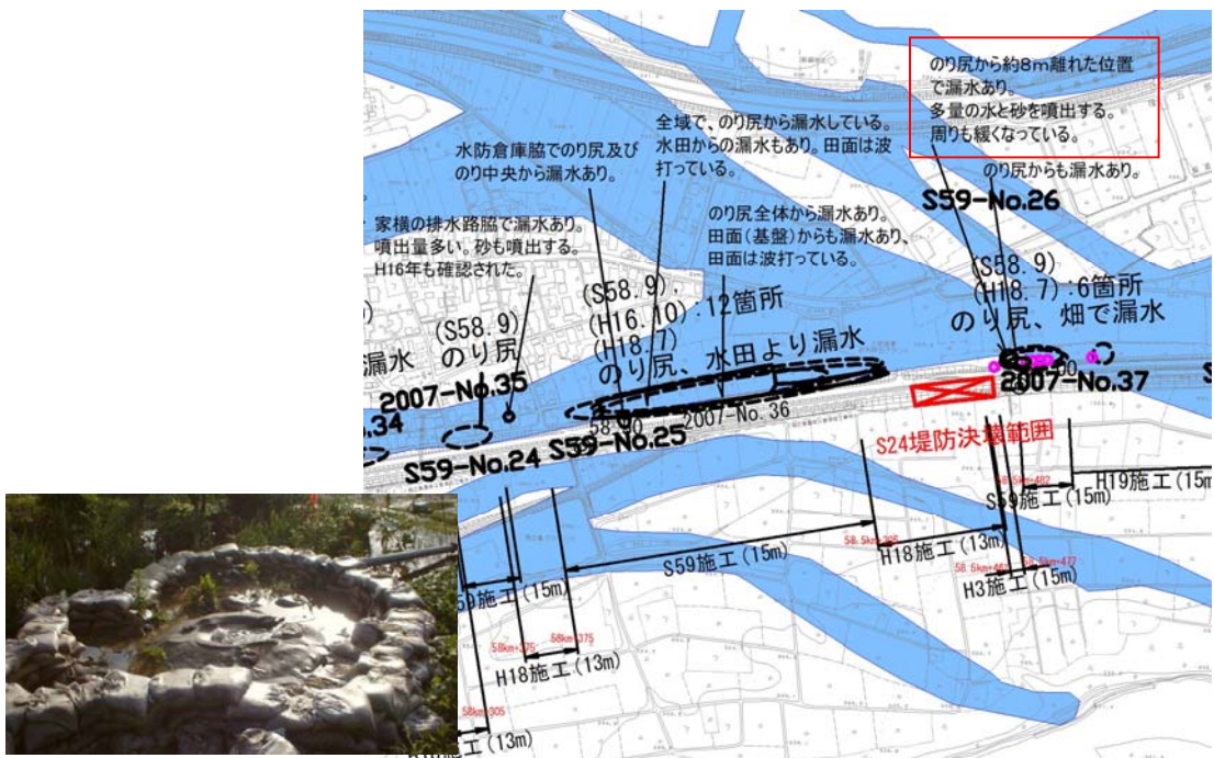
図 6-5-12 旧河道と堤防の交差状況と漏水発生位置 (村山下流地区 右岸 59.0kp 付近) 旧河道に囲まれている氾濫原で噴砂を伴う漏水が発生
