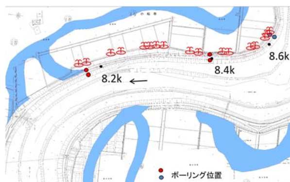
図5-3-1 古府地区の漏水発生位置
