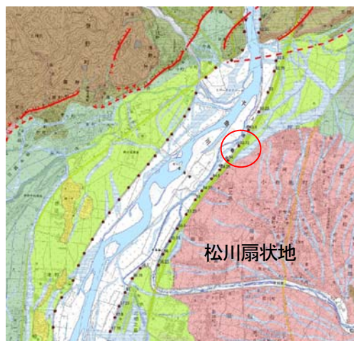
図 3-2-10 山王島地区の漏水発生概要 6)
