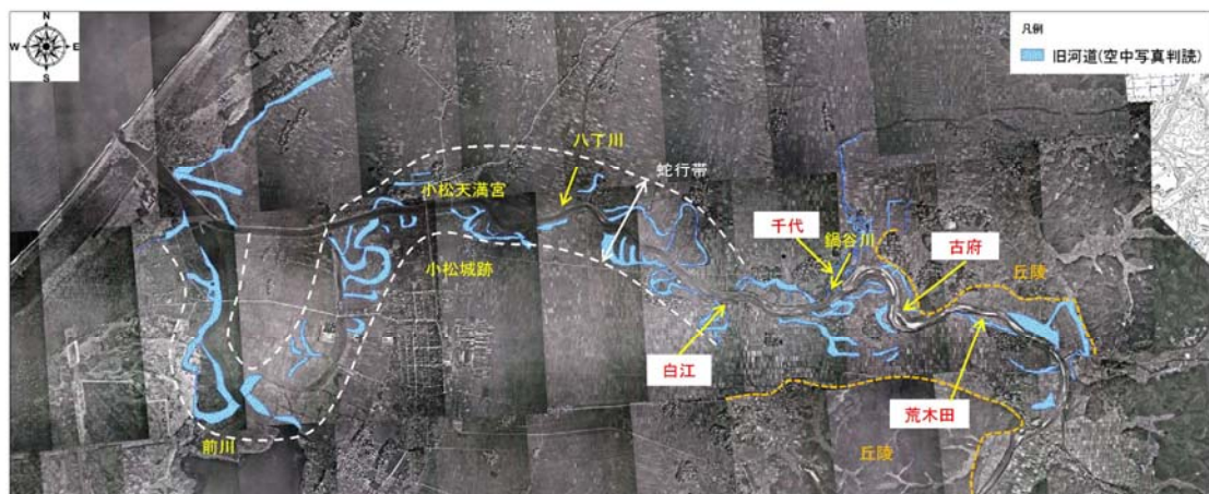
図 4-4-4 梯川の米軍撮影の空中写真による旧河道判読図と漏水発生箇所
