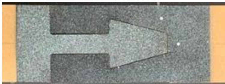
図 3-7 ランダムパターンを付与した試験片 (アガチス材)
