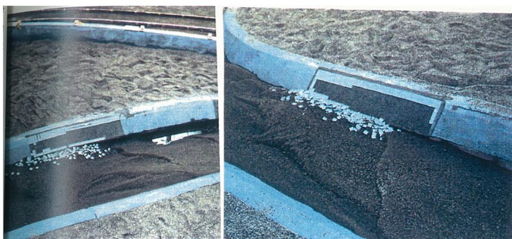
のり勾配1割のり留工のみ護岸破壊状況 ケース4(護岸模型3) のり覆工一体性弱い
