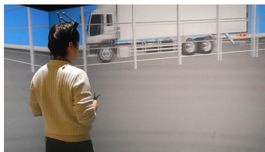
図－11 VR 技術を用いた騒音提示システム
