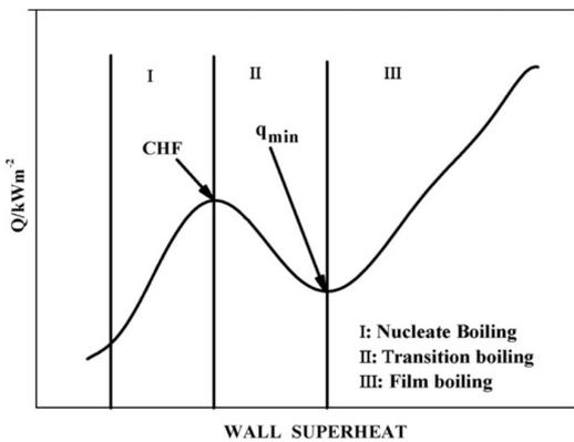
Fig. 1 Boiling curve<sup>(1)</sup>
