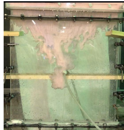
図-5(a) 実験の様子 流れ場の中心から左右2~3cmの範囲で流線が空洞に集まっていることがわかる
