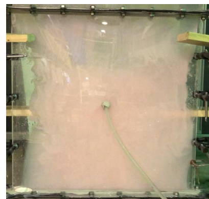
図-5(b) 実験の様子 流れの中心以外の流線は、空洞の影響を受けて曲線的に流れている
