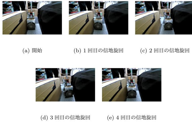
Fig.4.2 狭路での信地旋回を用いた横移動の様子
