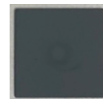
図 5.1 貧溶媒を用いた 2 ステップコーティングを用いた薄膜作製結果
