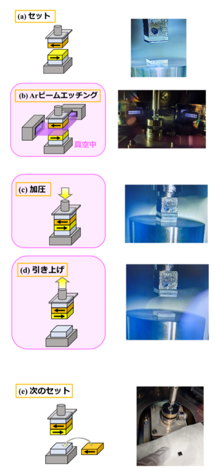
図4 YAGを用いた積層QPMデバイスの作製
