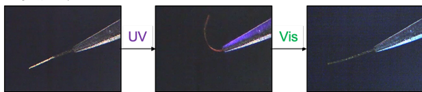
図2. 室温におけるフィルムの光屈曲挙動 (フィルムサイズ: 0.5 mm × 6 mm × 6 μm)
