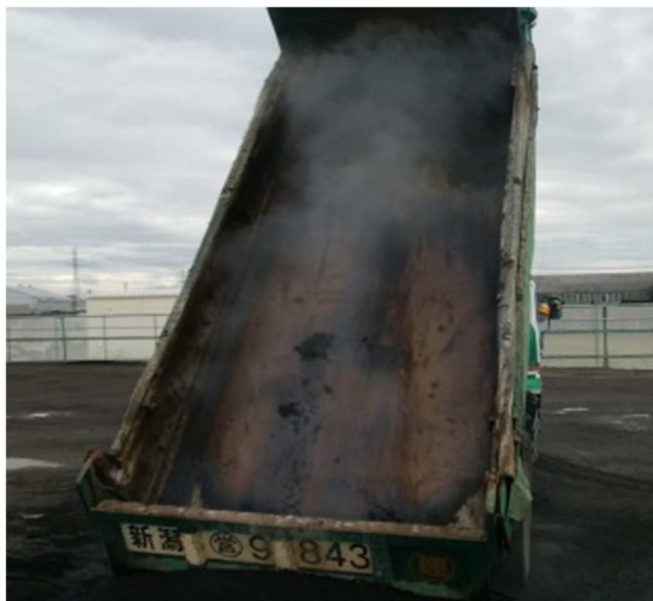
写真-3.6 ダンプトラック荷台への付着確認
