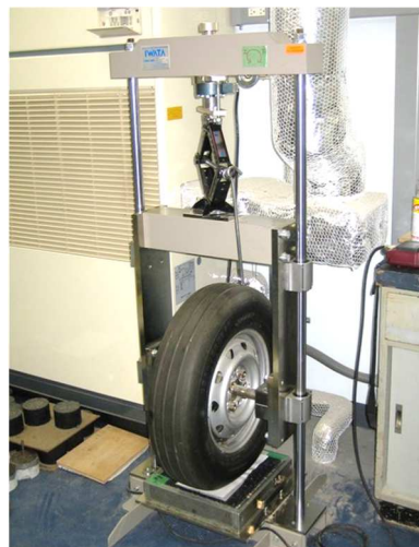
(b) 室内静的タイヤ载荷装置
