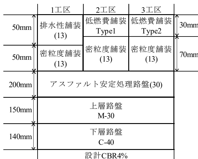
図-3.2 試験路面の断面構成
