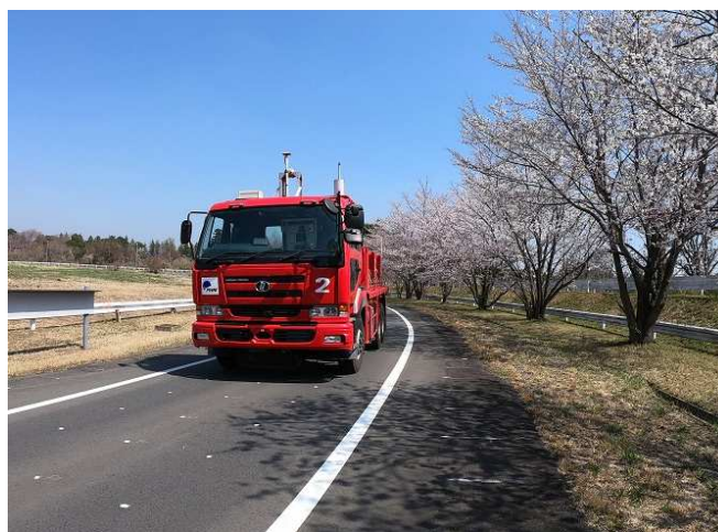
写真-3.3 荷重車走行状況
