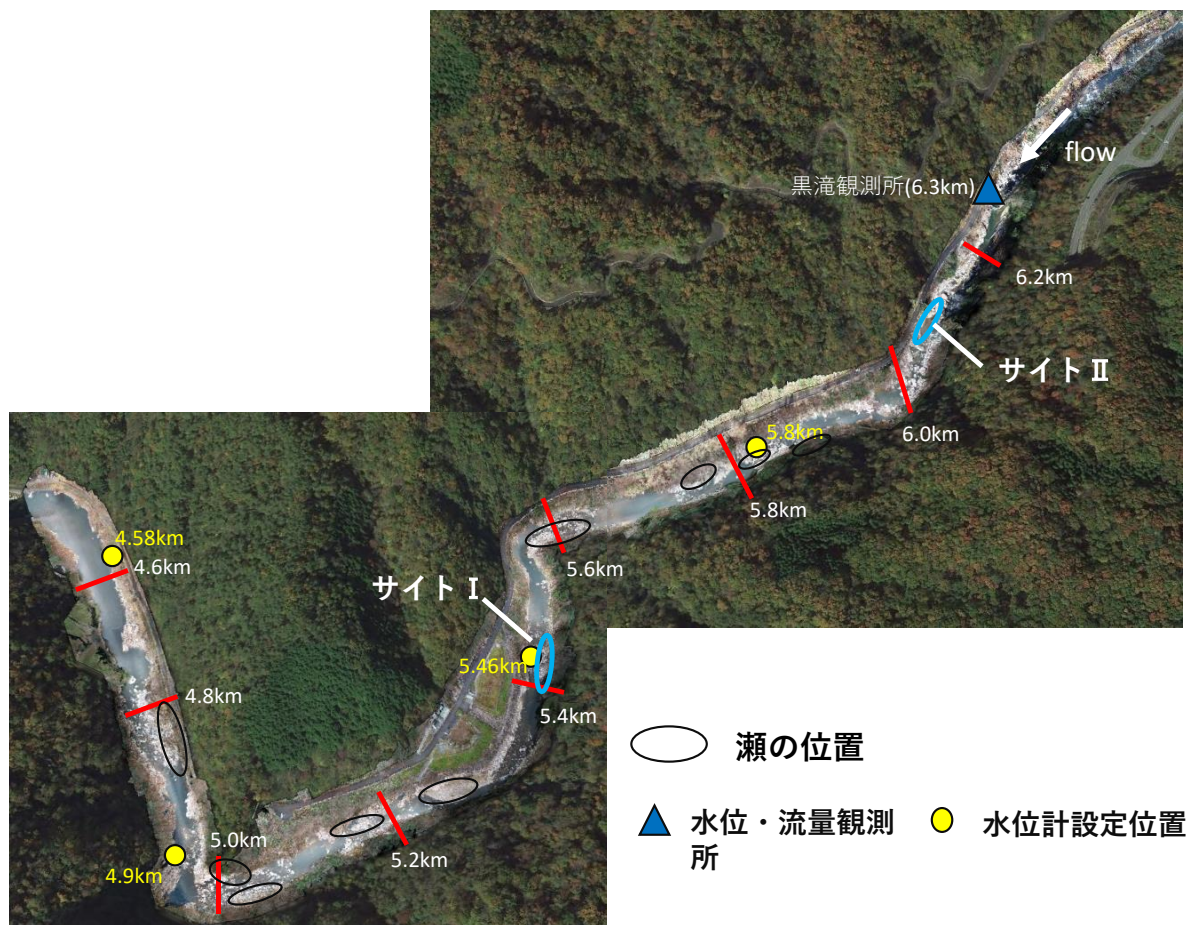
図 4-1 滝山川温井ダム上流部の航空写真と現地調査箇所の位置図
