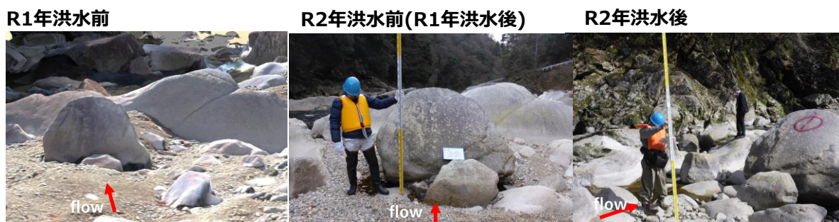
図 4-17 粗粒化した箇所での河床表層の状況の変化
