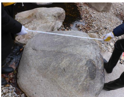
(a) 巨石の長径・中径・短径の計測
