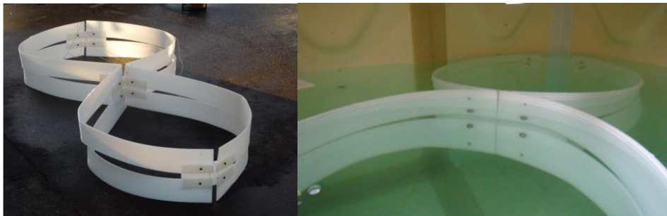
写真-7.1.2 8の字型浮体式制振装置 写真-7.1.3 8の字型浮体式制振装置の設置状況
