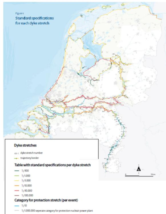
図 2.2.3 堤防の洪水防御基準<sup>34)</sup>
