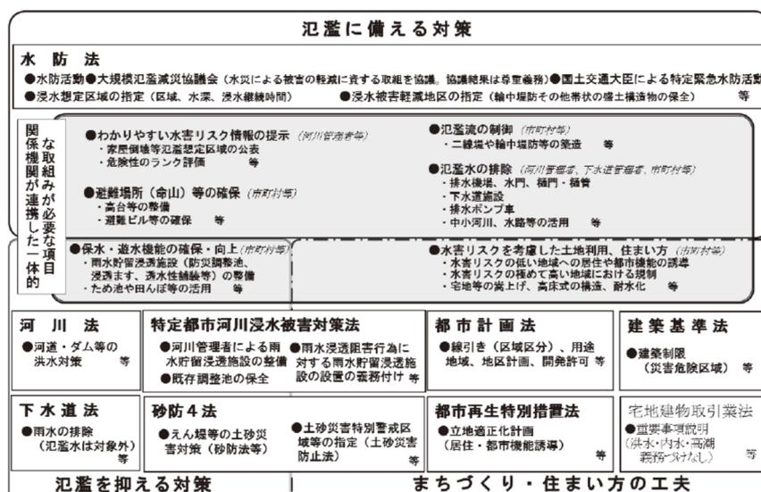
図 2.3.2 大規模氾濫時の被害軽減に向けた法律と対策項目の関係<sup>43)</sup>
