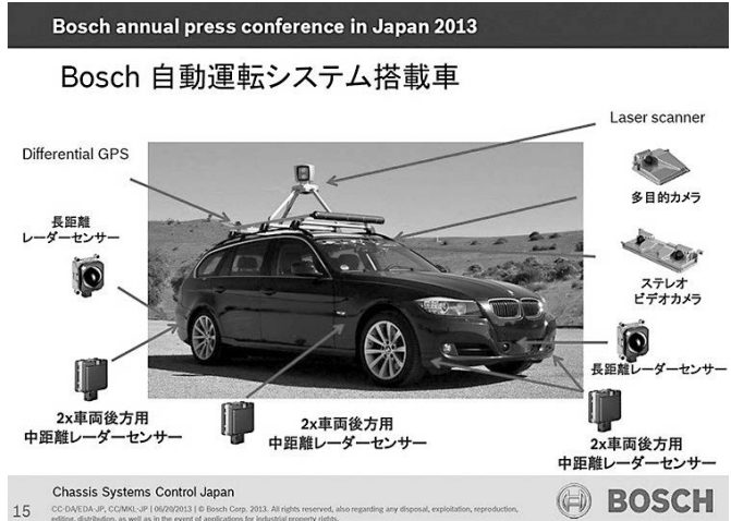
自動運転に搭載されているセンサー 出典：Bosch annual press conference in Japan 2013. https://globe.asahi.com/article/12777172
