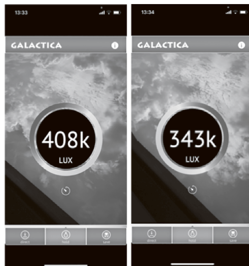
図7 照度と太陽電池パネルの関係 (左: ビーコン運用可能, 右: ビーコン運用不可能)
