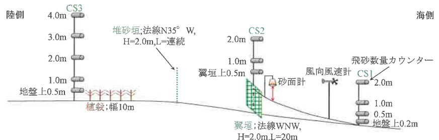
図-2 飛砂数量カウンター計，砂面計配置図
