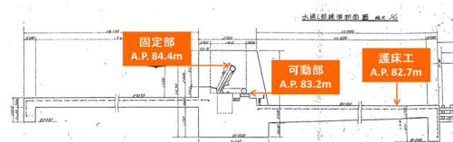
(c) 縦断面図 (可動堰部)
