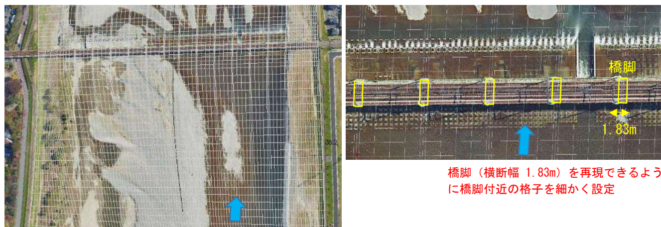
図4-14 京王線橋梁(35.1km)の橋脚とそれを再現するための解析格子
