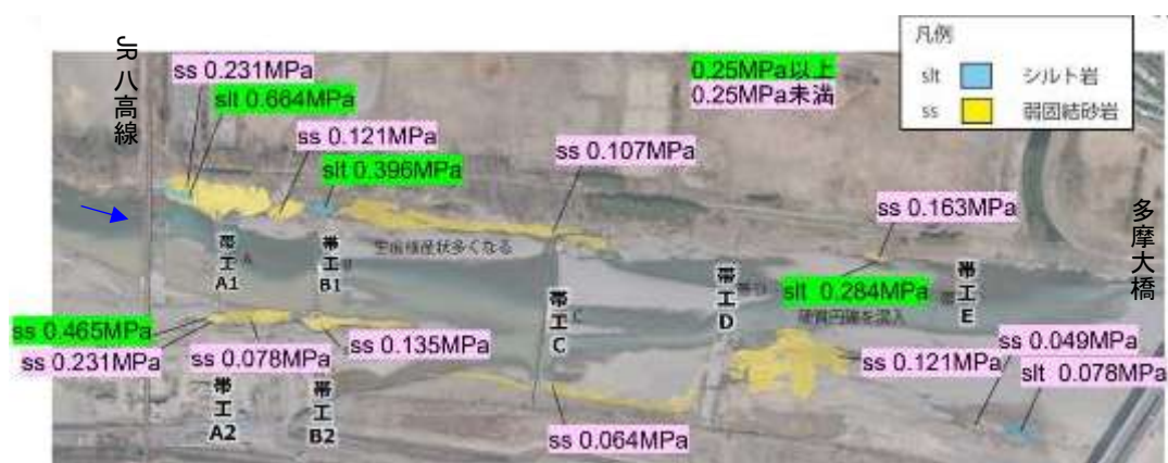
図3-33 土丹調査位置、表層の圧裂引張強度の調査結果 6)
