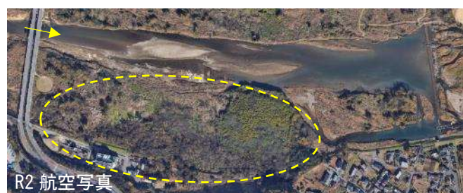
高水敷上の多くを樹木群落が占める場合 樹木群透過係数 K=40\text{m/s}
