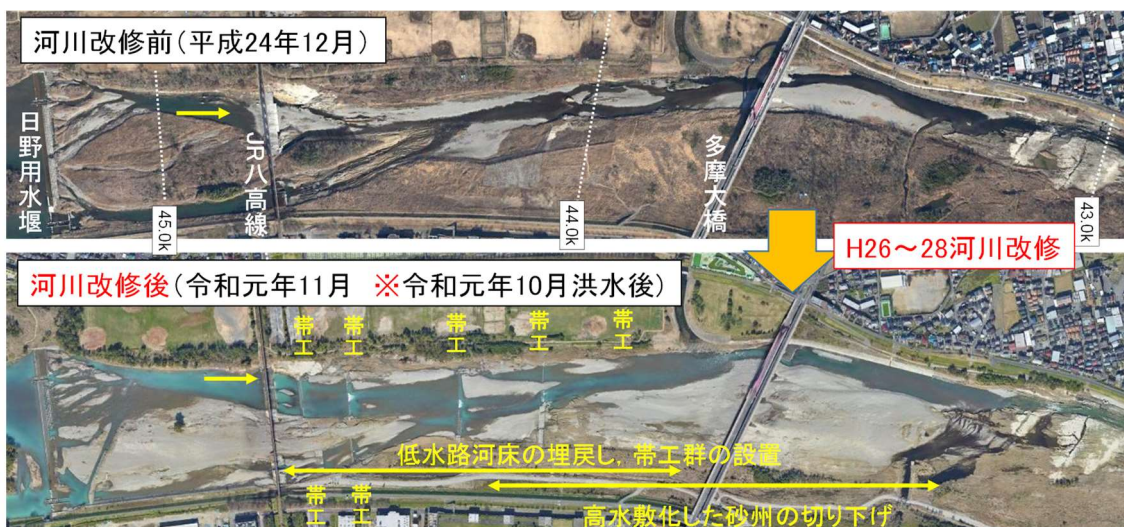
図 3-16 四谷本宿堰 (38.24km) の改築事業の概要
