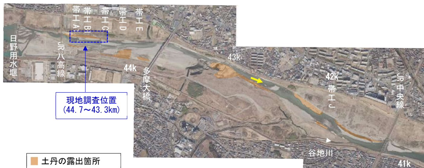
図3-20 令和元年10月洪水後の土丹の露出箇所(JR八高線～JR中央線区間)
