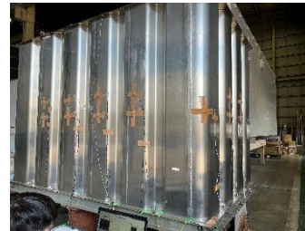
写真-1 ステンレス製一体型水槽
