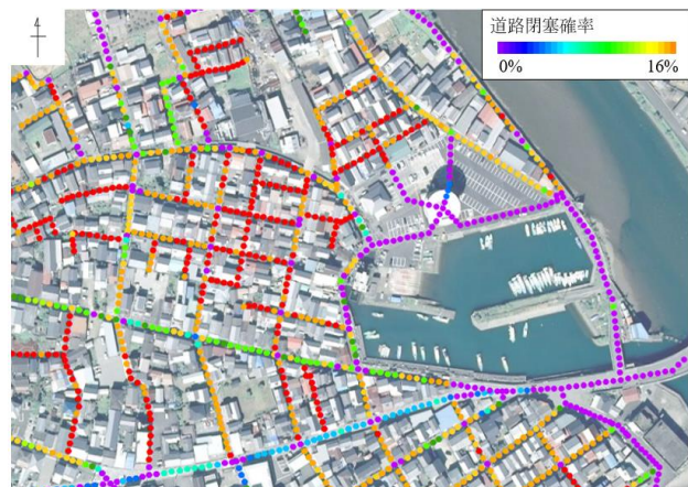
図-8 道路閉塞確率の算出結果(既往手法)
