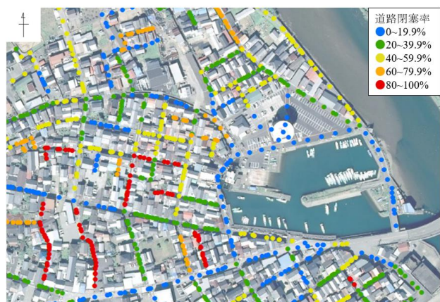
図-9 建物倒壊確率の算出結果と閉塞箇所(本手法)
