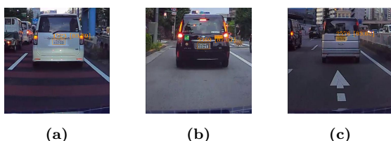
図 5: 提案手法でのナンバープレートの認識結果の例
