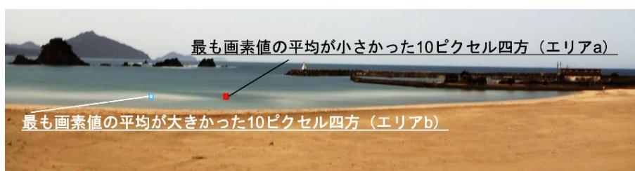
Fig. 3.1.9 砕波帯・離岸流域内で画素値の平均が最も小さかった・大きかった箇所の抽出
