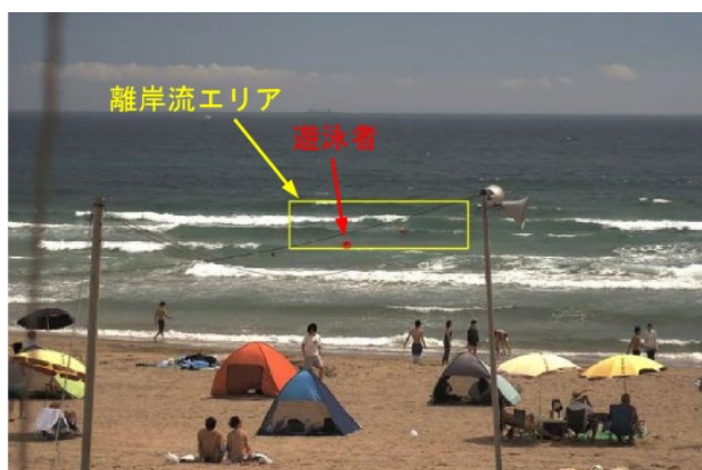
Fig. 2.1.3 離岸流検知システム 検知例
