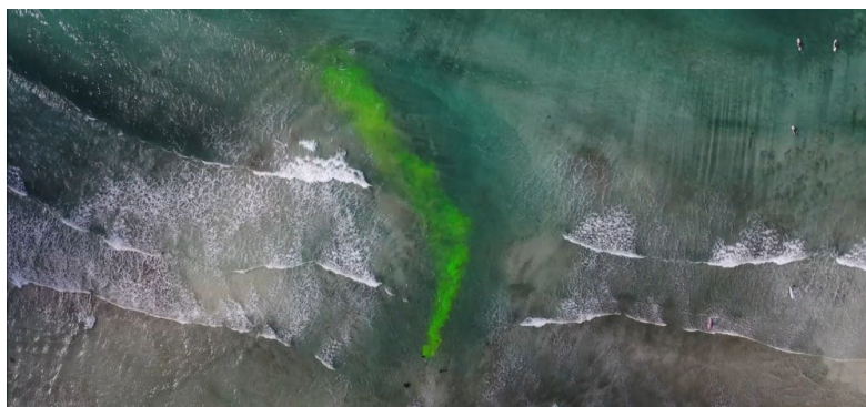
Fig. 3.1.6 染料調査にて観測された離岸流 (2021年2月24日)
