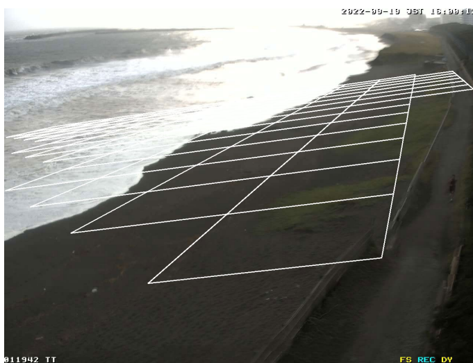
Fig. 6.2.7 改良仮想勾配法にて求めた遡上高が最も高かった時間帯の海岸（改良仮想勾配法：T.P. +2.5 m, 本手法：T.P. + 3.8 m）
