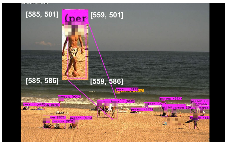
Fig. 4.1.2 AI による人検知例と取得した矩形情報
