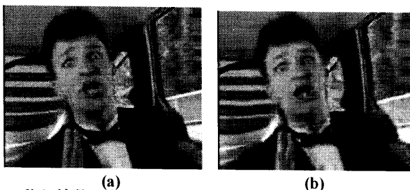
図 3.3 動き補償画像 (“Carphone”, R_f = 15 fps, R_d = 64 kbps, p = 10 画素、200 フレーム目), (a) FS. (b) BOSA.
