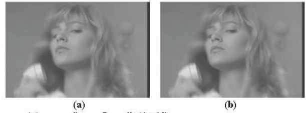
図 3.4 “Susie” の復号画像 (4Mbps, 30fps, p_1 = 64 ). (a)FS. (b) 本アルゴリズム
