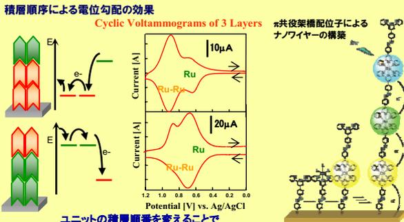
ユニットの積層順序を変えることで電流の流れやすさを制御できた
