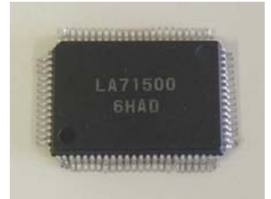
開発された世界最大級のバイポーラアナログLSI
