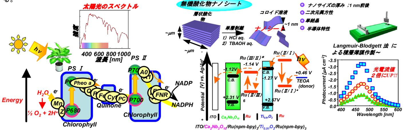
複合膜内に光合成に倣った電位の勾配膜の作成 ⇒ 電子移動のカスケード化による高効率化
