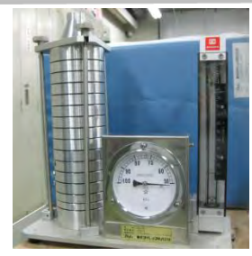
(左) キャンパス屋上でのサンプリングの様子 (上) 13段階に分級捕集するためのサンプラー
